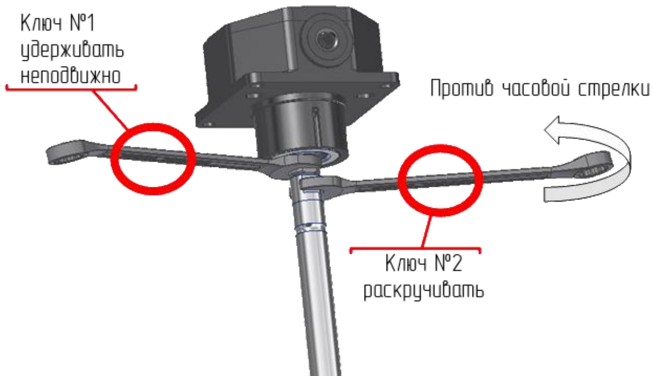
Рисунок 11. Демонтаж внутренней трубки датчика
