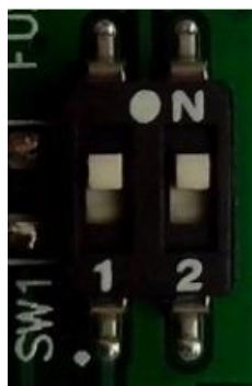
Малюнок 20. Перемикач узгоджуючих резисторів шини CAN та RS-485.
